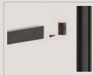
Comment fixer les profils horizontaux intermédiaires sur le profil vertical arrière.
