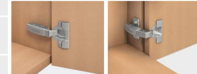
Application standard Charnières pour applications standards avec épaisseurs de face jusqu'à 24 mm Porte dans le prolongement Charnières pour fixation encastrée dans le prolongement et fixation dans le prolongement de la porte en applique
