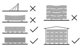
Les panneaux Valchromat doivent être stockés dans un endroit fermé, à l'abri de la lumière du soleil, à température et humidité contrôlées, supportés sur une base plane et horizontale. Les palettes doivent être posées sur des appuis d'une hauteur suffisante pour permettre un accès facile à l'aide d'un chariot élévateur. L'écart maximal entre les supports ne doit pas excéder 80 cm.
